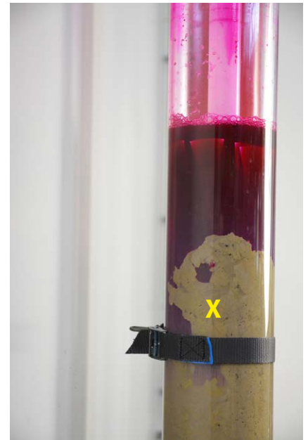
Detail product X doordringbaar, vloeistof zakt bij afpompen door bentoniet.
