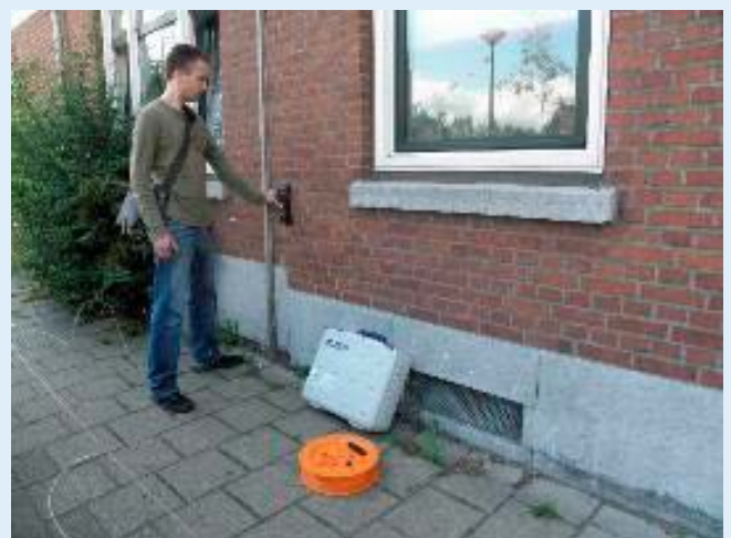
Figuur 23: Lintvoegmeting in de praktijk (gemeente Rotterdam)
