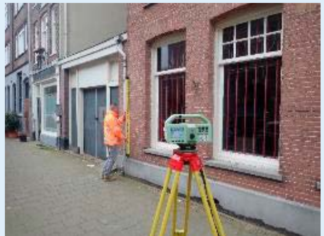
Figuur 29: Hoogtemeting NKW-Bout met Invar-baak (Fugro)
